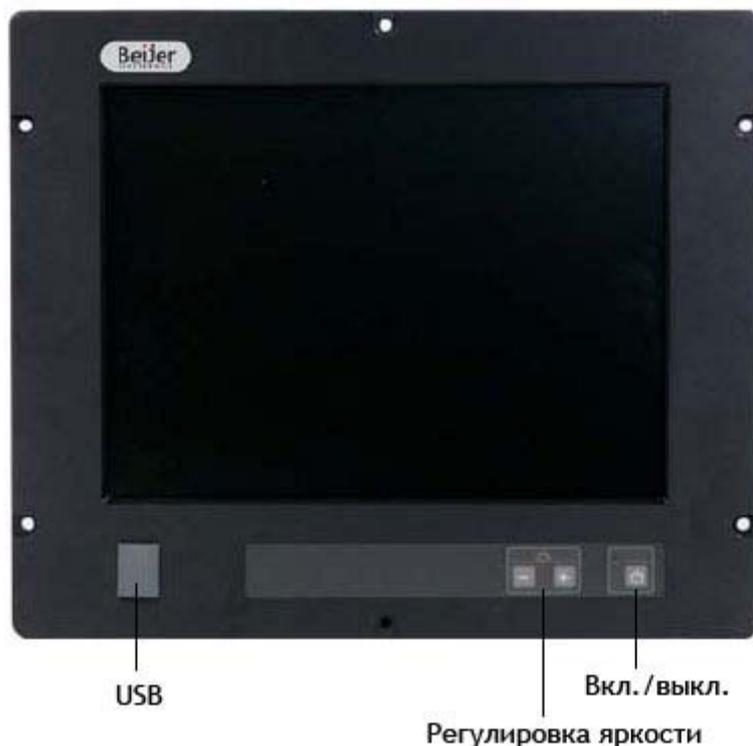
Лицевая панель содержит USB-порт, защищенный резиновой заглушкой, кнопку Вкл./Выкл. со светодиодом и кнопки регулировки яркости. Функции кнопок подробно объяснены ниже.
